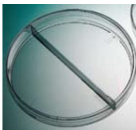
Petricsésze, 2 részre osztott, kerek, átmérő: 90mm, magasság: 14,2mm
